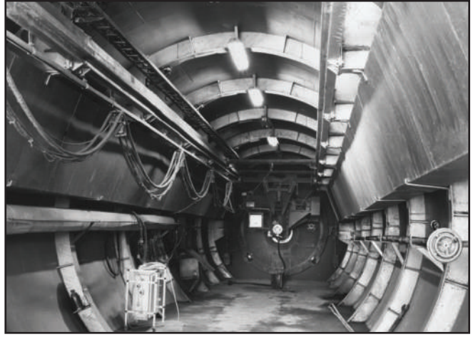
Unax tipi soğutuculu firmalarda, fırın çıkış gözetleme kısmı.
