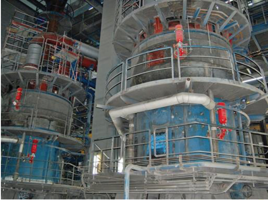
Fotoğraf 13 – Dikey Kömür Öğütücüsü Üzeri Aktif Patlama Söndürme Sistemi 24
