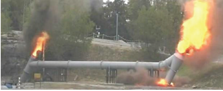
Fotoğraf 10 – Diverter Vana (flame front diverter)
