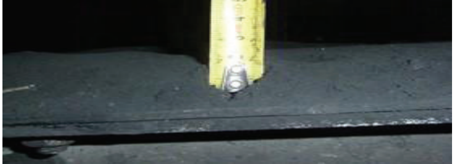
Fotoęraf 6 – Yüzeyde Toz Birikimi Derinlięi Ölçümü (2 cm)
