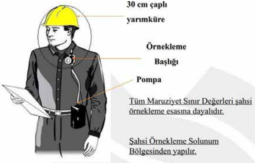
Şekil 1: Kişisel maruziyet toz ölçümü ve solunum alanı
